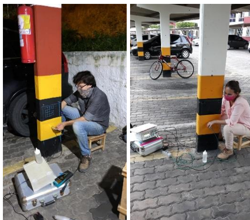
Figura 17 – Realização do ensaio de determinação da velocidade do pulso ultrassônico no concreto
