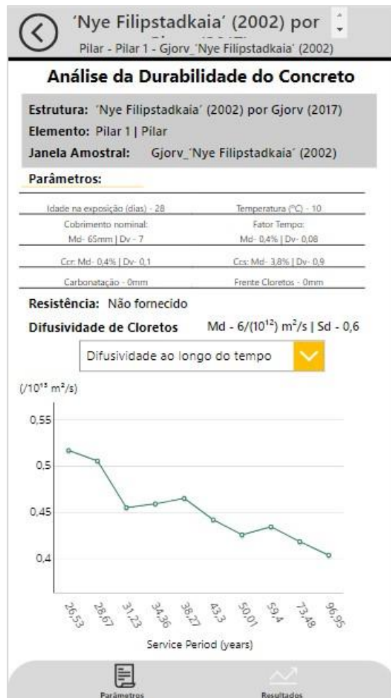
Figura 36 – Aba de resultados – Gráfico do coeficiente de difusão do íon cloreto no concreto ao longo do tempo.
