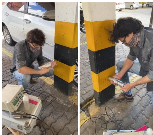
Figura 18 – Realização do ensaio de determinação da dureza superficial por esclerômetro de reflexão
