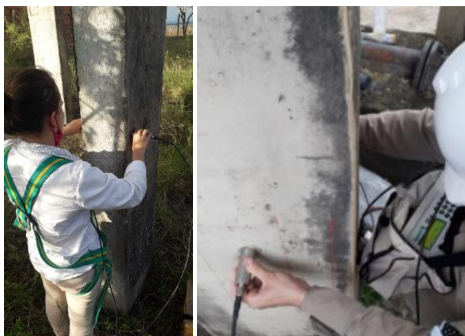
Figura 13 – Realização do ensaio de determinação da velocidade do pulso ultrassônico no concreto
