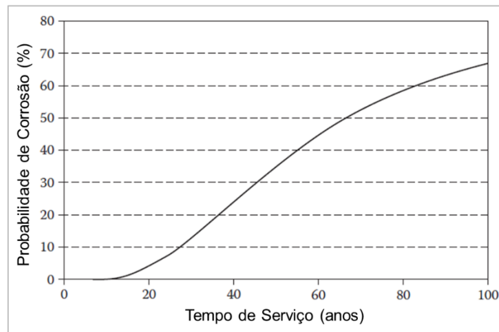
Figura 39 –Probabilidade de corrosão do 'Nye Filipstadkaia' (2002) obtido por Gjorv (2017) com uso do DURACON (2004)
