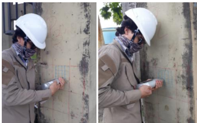
Figura 14 – Realização do ensaio de determinação da dureza superficial por esclerômetro de reflexão
