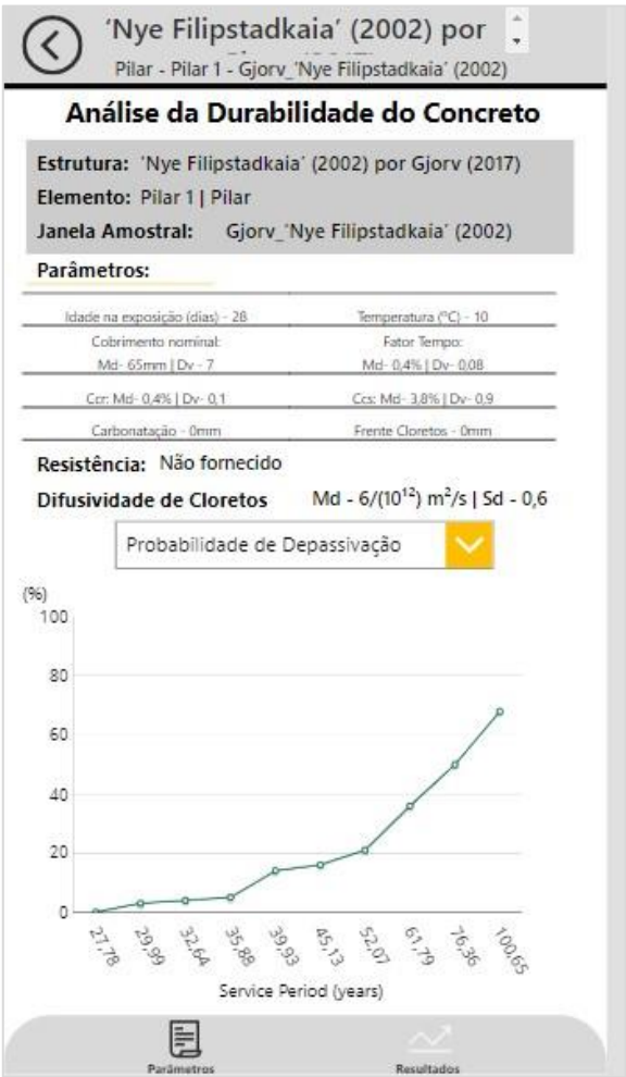
Figura 35 – Aba de resultados – Gráfico da probabilidade da despassivação do aço ao longo do tempo.
